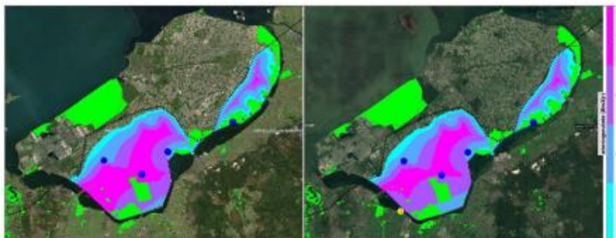
1 - figuur 1: Winningsruimte op basis van de gecombineerde criteria (verzilting en 10 cm stijghoogtedaling) zonder uitbreiding winning op oude land (links) en met een winning van 3 Mm3/jr op Eemdijk (rechts)
